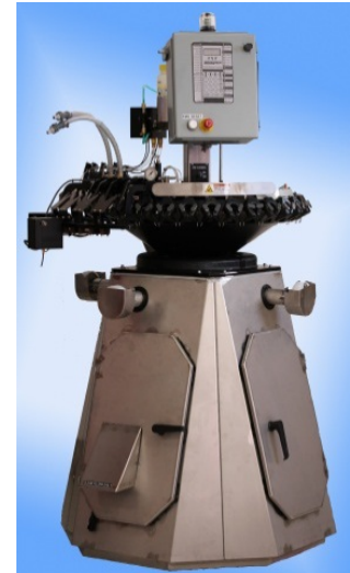
Figure 3 : Équipement de traitement du bec à l'infrarouge. Inclus avec la permission de Nova-Tech Engineering.
